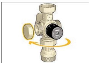
4. Posizionare il tubo di collegamento a destra, ruotandolo di 180° rispetto al suo asse.
