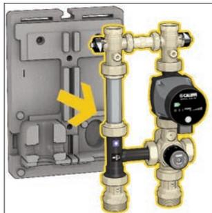
2. Svitare completamente le calotte mobili (tramite delle idonee chiavi) poste sotto le valvole di intercettazione di mandata e ritorno. Svitare anche le calotte mobili presenti sulla valvola miscelatrice, rimuovere la valvola e la pompa
