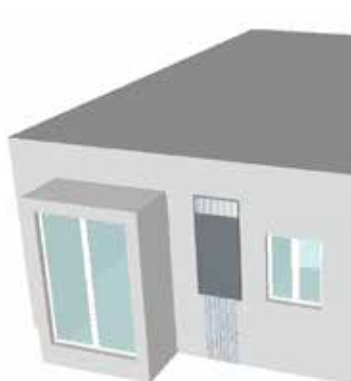
Installazione incasso esterno con presa esterna ed espulsione diretta utilizzando kit prese esterne (accessorio)
