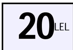
Il display visualizza una concentrazione di gas Esplosivo in% del LEL (L.I.E.)
