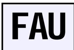
Il display visualizza una avaria della sonda che rileva gas Esplosivo
