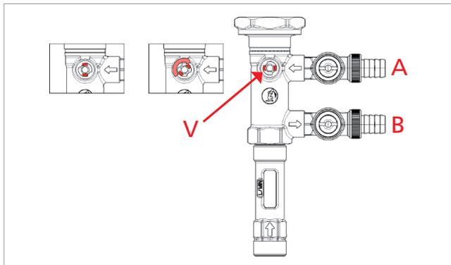
• Valvola a sfera integrata nel gruppo di circolazione per il sezionamento dei collettori solari dall'impianto, è dotata di valvola di non ritorno per impedire circolazioni indesiderate. Qualora, in particolari condizioni di funzionamento (per esempio durante la fase di caricamento dell'impianto), fosse necessario far circolare il fluido termovettore anche nel senso opposto a quello ordinario, è possibile aprire la valvola di non ritorno utilizzando l'apposita chiave **A** per manovrare le aste.
